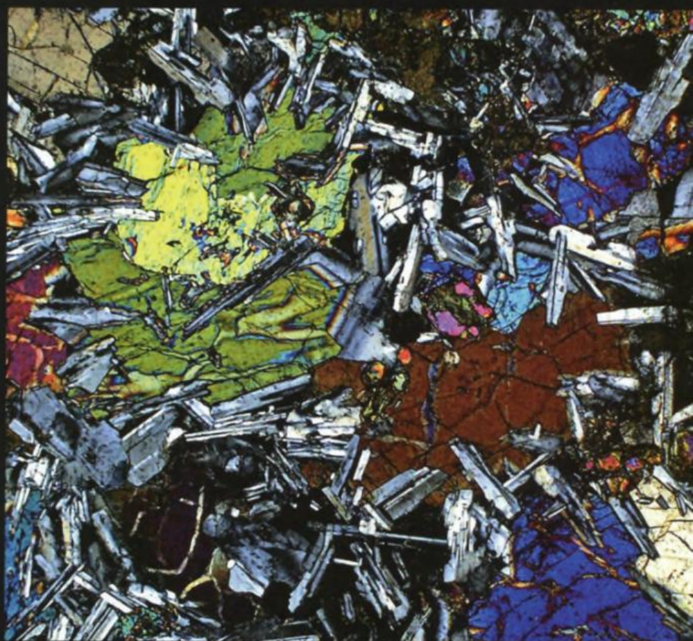
Это шлифы (тонкие срезы) горной породы — долерита. Фото сделано с помощью поляризационного микроскопа.
